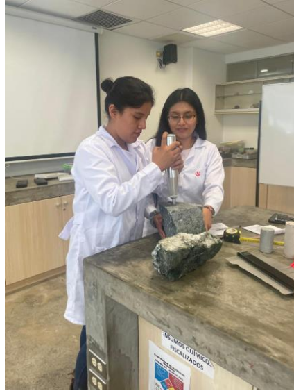
Figura 21 Ensayo de laboratorio con el martillo Schmidt
