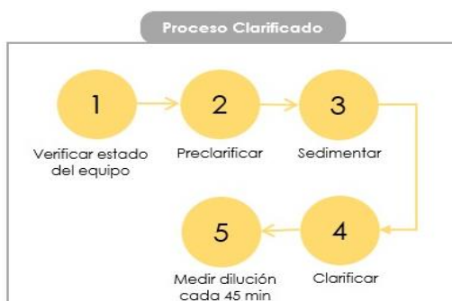
Figura 6: Método de Clarificado posterior a la mejora
