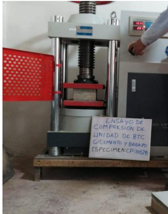
Figura 2. Ensayo de resistencia a la compresión de BTC.
