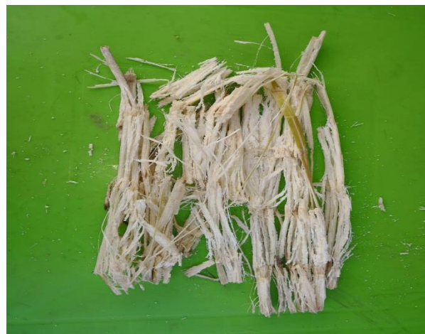
Figura 1. Fibras cortadas del bagazo de caña de azúcar.
