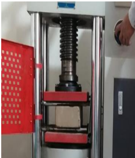
Figura 3. Ensayo de resistencia a la flexión de BTC.
