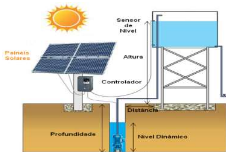
Fig. 3. Esquema de un pozo tubular Fuente: Aguamarket Año: 2016
