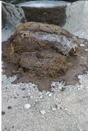
Figura 24. Estado de la mezcla tipo 1 luego del ensayo de inmersión de veinticuatro horas. Fuente: Propia.
