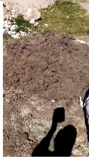
Figura 10. Ejemplo dos de ruma de mezcla humedecida para incorporación de Ichu y virutas de Eucalipto. Fuente: Propia.
