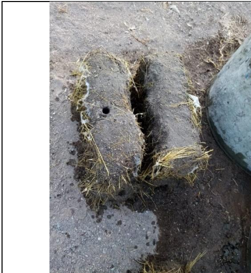
Figura 18. Estado de la mezcla tipo 1 luego del ensayo de inmersión de una hora. Fuente: Propia.
