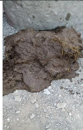
Figura 25. Estado de la mezcla tipo 2 luego del ensayo de inmersión de veinticuatro horas. Fuente: Propia.
