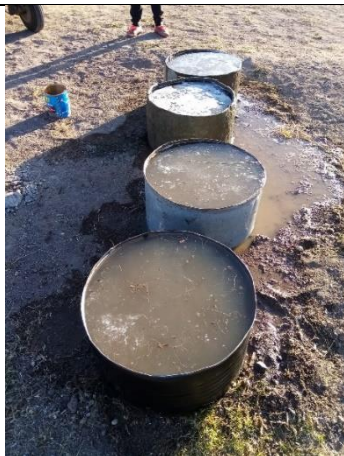
Figura 16. Cilindros llenos de agua para ensayo de inmersión de una hora. Fuente: Propia.
