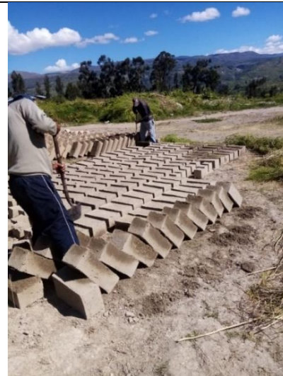
Figura 15. Volteo de adobes luego de 15 días de secado. Fuente: Propia
