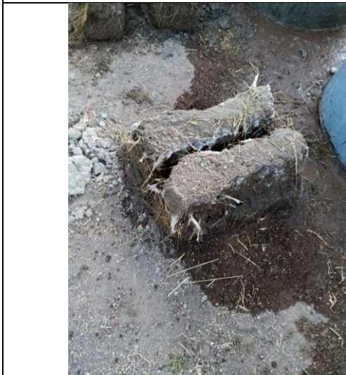
Figura 20. Estado de la mezcla tipo 3 luego del ensayo de inmersión de una hora. Fuente: Propia.
