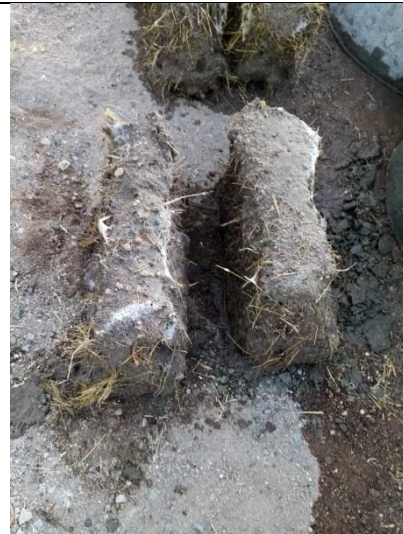
Figura 19. Estado de la mezcla tipo 2 luego del ensayo de inmersión de una hora. Fuente: Propia.
