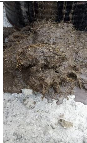
Figura 27. Estado de la mezcla tipo 4 luego del ensayo de inmersión de veinticuatro horas. Fuente: Propia.
