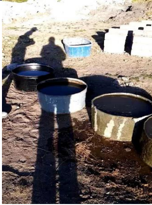
Figura 22. Cilindros llenos de agua para ensayo de inmersión de veinticuatro horas. Fuente: Propia.
