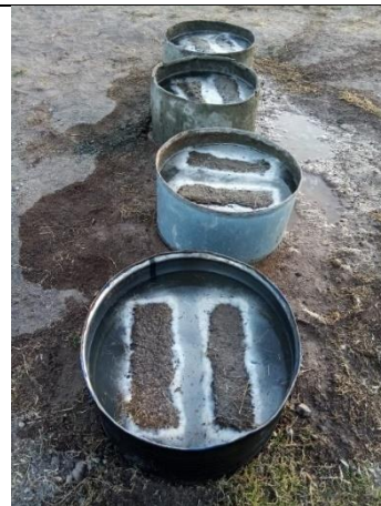
Figura 17. Inserción de dos adobes dentro de los cilindros para ensayo de inmersión de una hora. Fuente: Propia.
