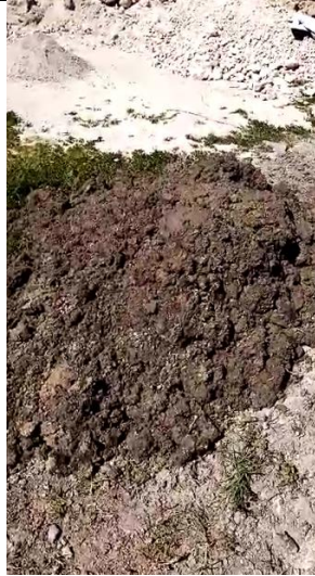
Figura 9. Ejemplo uno de ruma de mezcla humedecida para incorporación de Ichu y virutas de Eucalipto. Fuente: Propia.
