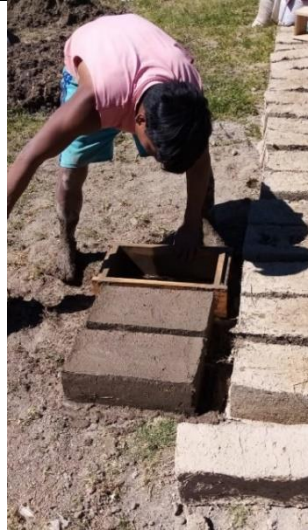
Figura 13. Proceso de moldeado del adobe. Fuente: Propia.
