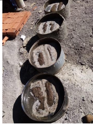
Figura 23. Inserción de dos adobes dentro de los cilindros para ensayo de inmersión de veinticuatro horas. Fuente: Propia.
