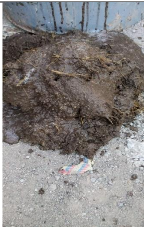
Figura 26. Estado de la mezcla tipo 3 luego del ensayo de inmersión de veinticuatro horas. Fuente: Propia.
