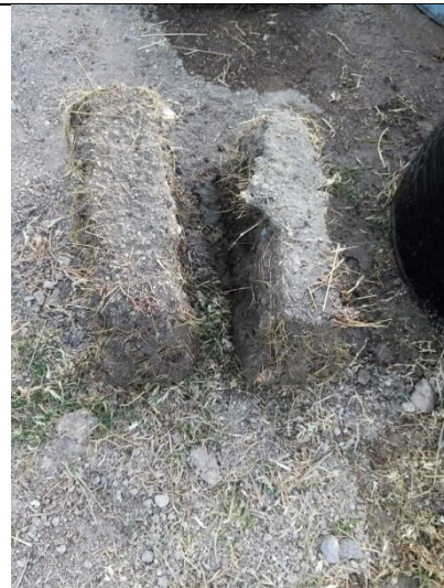
Figura 21. Estado de la mezcla tipo 4 luego del ensayo de inmersión de una hora. Fuente: Propia.
