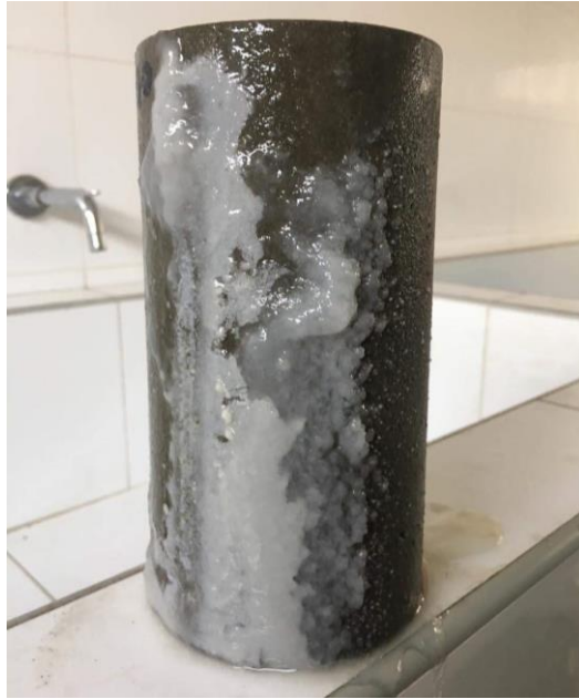
Figura 7. Probeta de concreto expuesta durante 90 días a la solución de sulfato de magnesio
