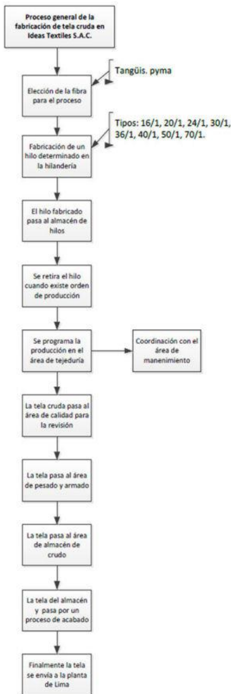
Gráfico N°1: Proceso general de fabricación de tela cruda
